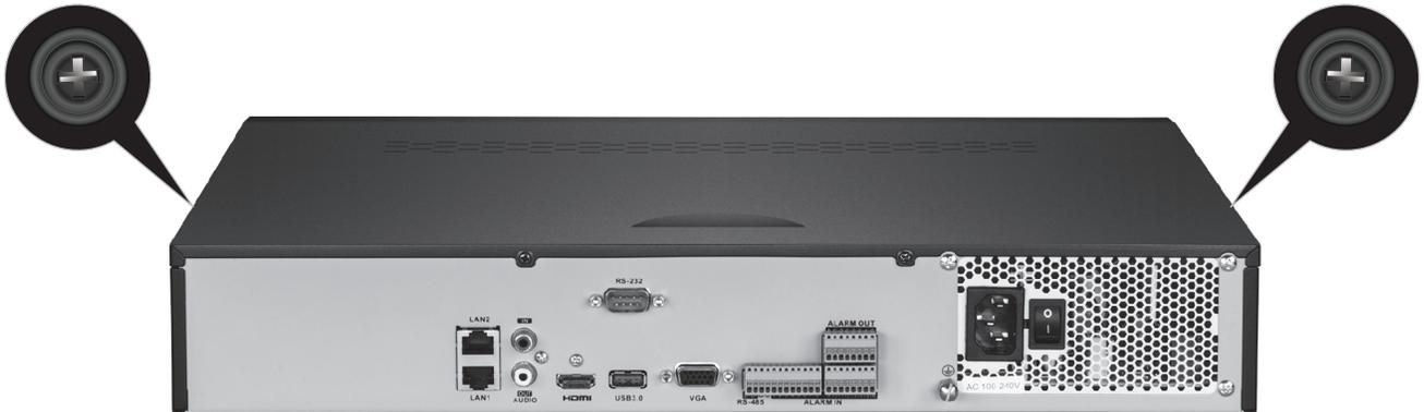
2. Schieben Sie die Abdeckung vom Gerät ab, indem Sie die Abdeckplatte zur Rückplatte hin ziehen.
