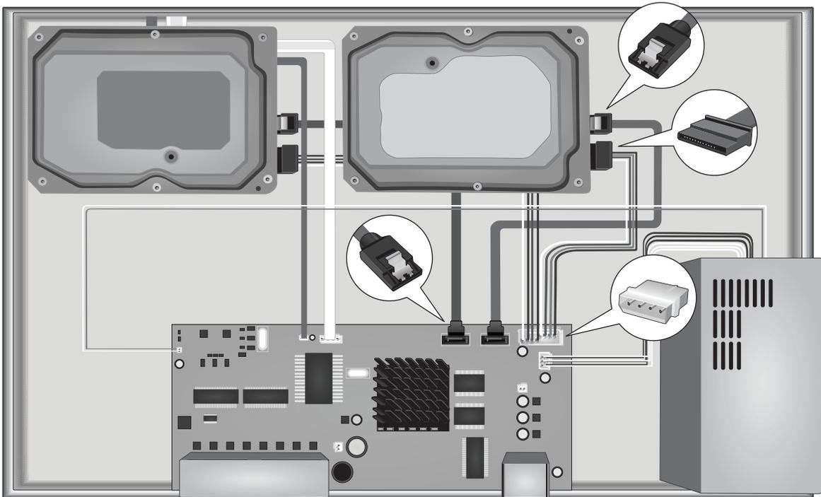
4. Befestigen Sie die Festplatten mit den Befestigungsschrauben in den Festplattenbuchten des NVR, indem Sie die Schrauben von der Unterseite des NVR in das Gehäuse der Festplatte schrauben.
