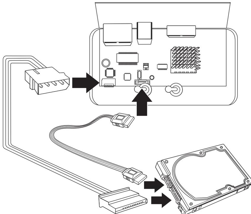
4. Monte la unidad de disco duro en la unidad TV-NVR104 utilizando los tornillos de montaje incluidos con su unidad de disco duro.
