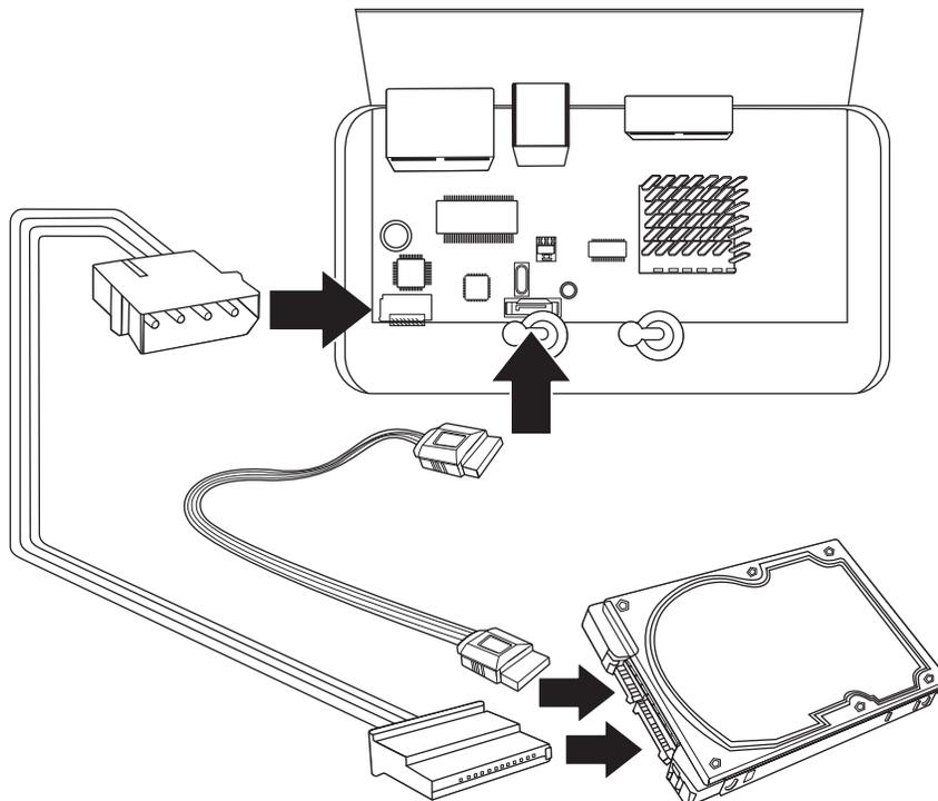
4. Montare il disco nell'alloggiamento apposito del TV-NVR104 usando le viti incluse nell'unità disco.
