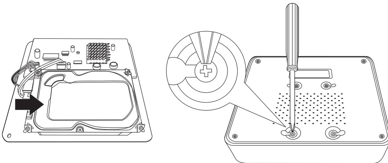
5. Bringen Sie die obere Abdeckung wieder am Gerät an. Stellen Sie sicher, dass die Bodenplatte an den Rillen der Abdeckung ausgerichtet ist.
