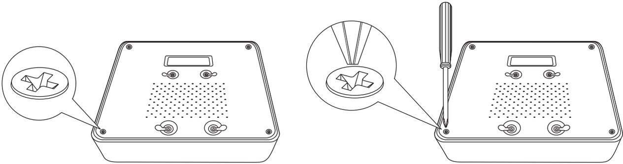
2. Die obere Abdeckung enthält vertikale Schlitz. Schieben Sie die Abdeckung von der Rückseite des Geräts vorsichtig hoch, um sie von der Bodenplatte zu trennen.
