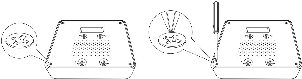
2. Le couvercle est glissé verticalement. Depuis l'arrière de l'appareil, faites doucement glisser le couvercle vers le haut afin de le séparer du panneau inférieur.
