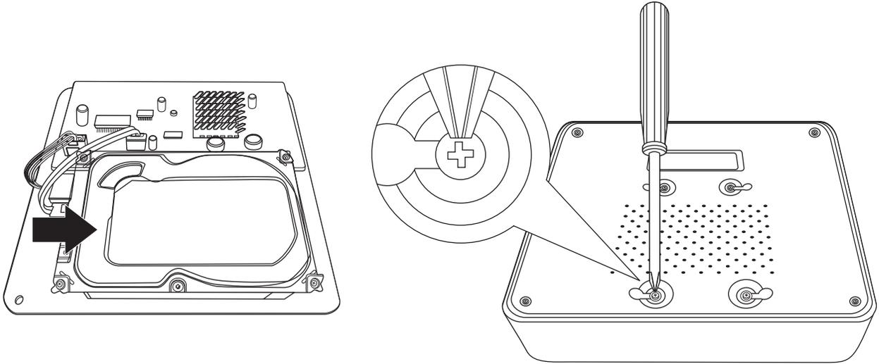
5. Revissez le couvercle à l'appareil. Assurez-vous que le panneau inférieur est bien aligné sur les fentes du couvercle.
