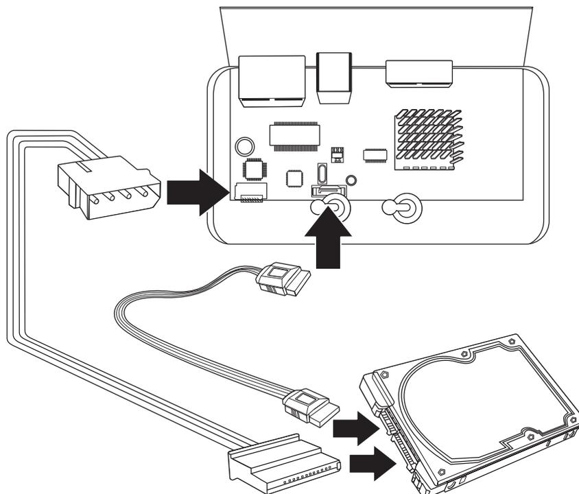
4. Fixez le disque dur à la baie du disque dur TV-NVR104 en utilisant les vis de fixation fournies avec votre disque dur.
