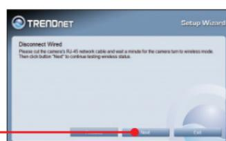
**Примечание:** устройство TV-IP612WN не будет производить беспроводное подключение до тех пор, пока не будет отсоединен кабель Ethernet от задней панели камеры.
