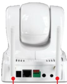
8. Подключите сетевой кабель RJ- 45 к коммутатору/маршрутизатору и к порту **Ethernet** IP-камеры.
