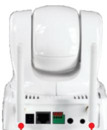
8. Verbinden Sie den Ethernet-Port der IP-Kamera über ein RJ-45-Netzwerkkabel mit einem Switch/Router.
