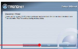
**Remarque:** Le TV-IP602WN ne fonctionnera pas sans fil avant que vous débranchez le câble Ethernet à l'arrière de la caméra.
