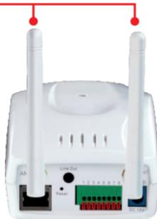
8. Подключите сетевой кабель RJ-45 к коммутатору/маршрутизатору и к порту Ethernet IP-камеры.
