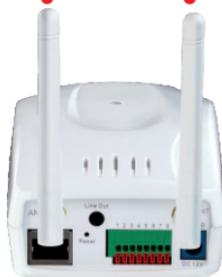
8. Conecte um cabo de rede RJ-45 do Switch/Roteador à porta **Ethernet** da Câmera Internet.
