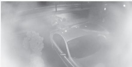
Esto se debe al reflejo de IR/vertido en la lente. La luz de IR puede estar reflejándose en la superficie de la cubierta del domo o en objetos cercanos. Las posibles causas del reflejo de IR se indican en la Figura 2.
