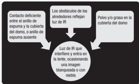
El caso más crítico de reflejos de IR es que el anillo de espuma no esté suficientemente apretado al domo de la cámara. Esto producirá un efecto de "NIEBLA CIRCULAR" (Figura 3).
