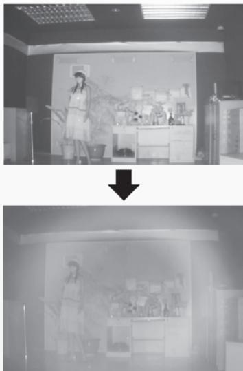
La **Figura 4** enseña el efecto de un pequeño trozo de cartón colocado solo a 1 cm del lado de la cámara. Aunque no está visible en la imagen (el cartón está fuera del campo de visión de la cámara), su efecto es tremendo. Para evitar esta situación:
