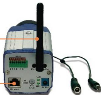
4. Conecte o Adaptador de Energia AC a Câmera Internet e depois a uma saída de energia.
