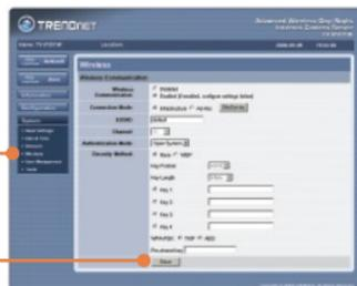
Nota: O TV-IP301W não funcionará de forma wireless até que você desconecte o cabo Ethernet da parte de trás da câmera.
