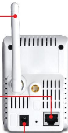
2. Branchez un câble réseau RJ-45 entre le Switch/Routeur et le port Ethernet de la caméra IP.
