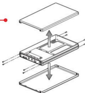
2. Desaparafuse a placa de circuitos do TU3-S25.
