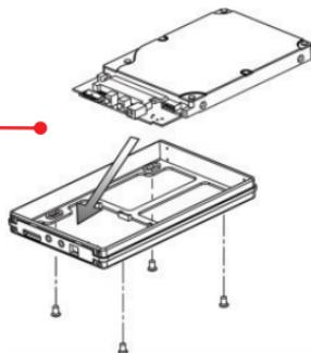
5. Reposicione a tampa e fixe-a com os 4 parafusos.
