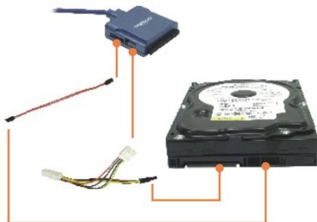
Примечание: Если у жесткого диска SATA уже имеется 4-контактный силовой разъем, используйте тогда его. Для соединения с жестким диском IDE и SATA, используя 4-контактный силовой разъем, потребуется 4-контактный силовой разъем типа Y, чтобы сделать из одиночного 4-контактного силового разъема двойной 4-контактный разъем.
