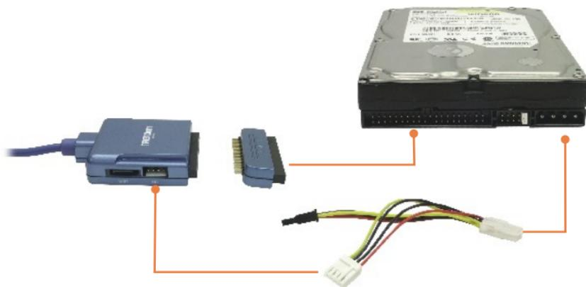
5. Присоедините одиночный разъем вывода DC (пост. ток) силового адаптера к гнезду DC IN на адаптере. Затем присоедините питающий провод из комплекта к силовому адаптеру, а другой конец к гнезду AC.
