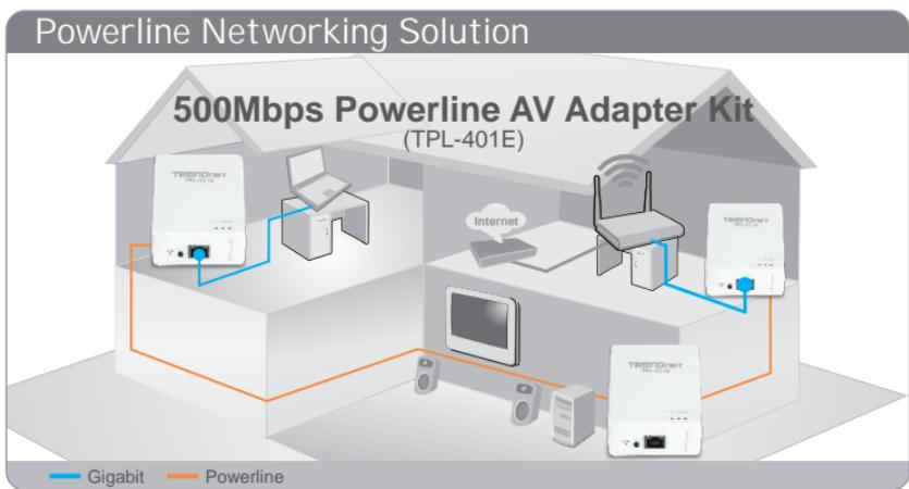
На диаграмме представлен пример типичной конфигурации домашней сети Powerline с 3 адаптерами, установленными в разных комнатах. Оранжевым цветом показаны соединения Powerline через электропроводку дома, а синими –кабели Ethernet Cat. 5, 5е, 6, при помощи которых к адаптерам подключаются сетевые устройства (компьютер, маршрутизатор, IP-теле приставка).
