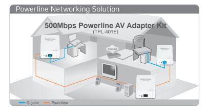
На диаграмме представлен пример типичной конфигурации домашней сети Powerline с 3 адаптерами, установленными в разных комнатах. Оранжевым цветом показаны соединения Powerline через электропроводку дома, а синими –кабели Ethernet Cat. 5, 5е, 6, при помощи которых к адаптерам подключаются сетевые устройства (компьютер, маршрутизатор, IP-телеприставка).
