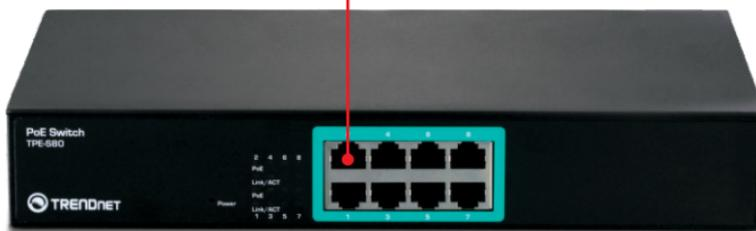
4. Присоедините кабель RJ-45 от порта PoE на устройстве TPE-S80 к порту LAN на устройстве PoE (напр., TEW-638PAP)
