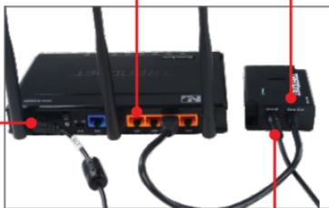
4. Присоедините кабельную перемычку из комплекта к устройству, не поддерживающему режим PoE (напр., TEW-639GR) и устройству TPE-112GS.
