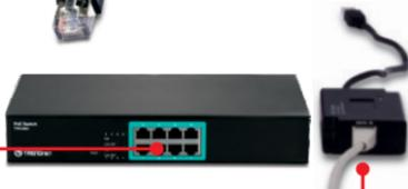
3. Подключите встроенный кабель Ethernet устройства TPE-112GS к порту LAN (ЛС) устройства, не поддерживающего PoE (напр., TEW-639GR).
