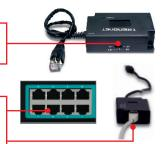
Присоедините кабель Ethernet от порта РоЕ (1~16) на коммутаторе TPE-S160 к порту РОЕ IN на устройстве TPE-112GS.
