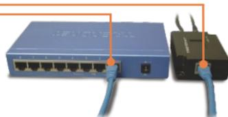
3. Присоедините кабель Ethernet от порта **Data-Out** на устройстве TPE-102S к порту LAN, устройства, не работающего в режиме PoE (например, TEW-450APB).
