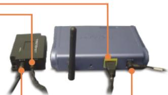
4. Присоедините кабельную перемычку из комплекта к устройству, не поддерживающему режим PoE (напр., TEW-450APB) и устройству TPE-102S.
