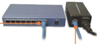
3. Присоедините кабель CAT-5 от устройства, работающего в режиме PoE (напр., TEW-434APB) к порту **PoE Out** устройства TPE-101I.
