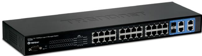
Коммутатор 2-го уровня на 24 порта 10/100 Мбит/с с 4 портами Gigabit Ethernet и 2 совмещенными разъемами mini-GBIC - надежная основа для создания управляемой сети с высоким уровнем масштабируемости.
