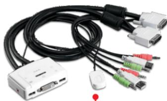
Presione el botón del interruptor de palanca para cambiar al otro PC
