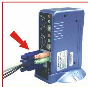
3. Присоедините каждый комплект используемых в системе кабелей KVM к разъемам каждого компьютера: видео, PS/2, мыши, USB, динамиков и микрофона.
