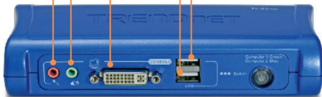
3. Utilisez les câbles KVM et USB pour brancher vos PC au Switch KVM.
