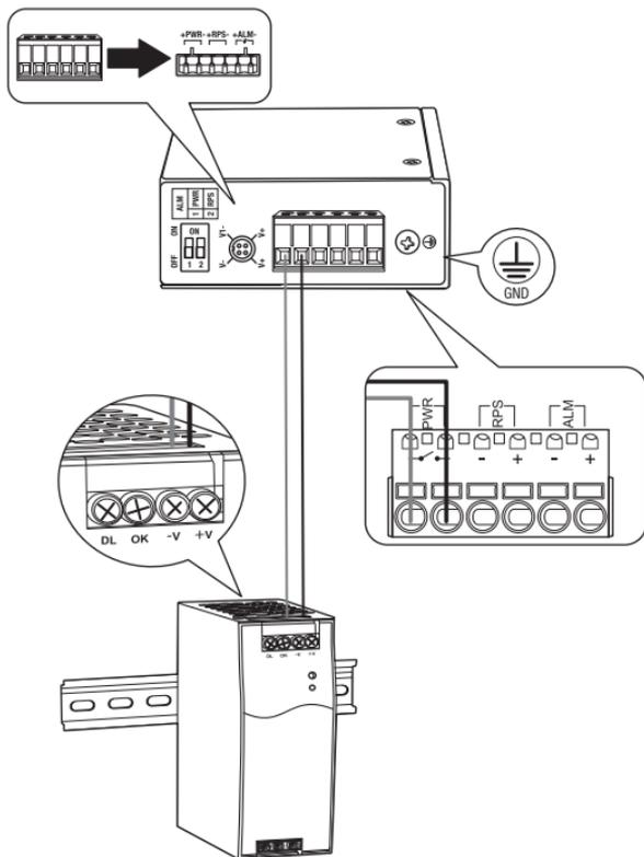
3. Conecte una fuente de red y dispositivos al switch. Compruebe los LED para confirmar que las conexiones estén establecidas. Su instalación ha finalizado.
