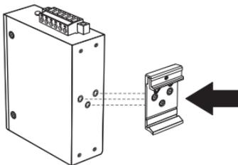
2. Coloque la unidad en frente del DIN-Rail y enganche el soporte de montaje en el carril.
