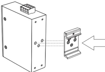
2. Posicione o unidade na frente do trilho DIN e enganche o suporte de montagem na parte superior do trilho.
