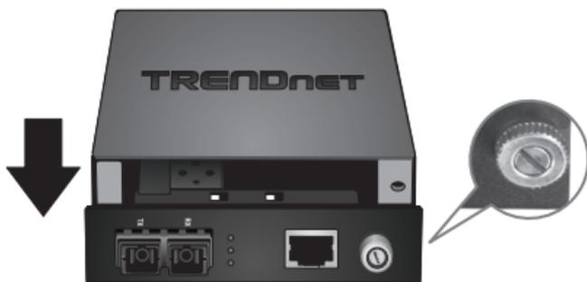
3. Вставьте конвертер в нужный отсек и закрутите барашковый винт.
