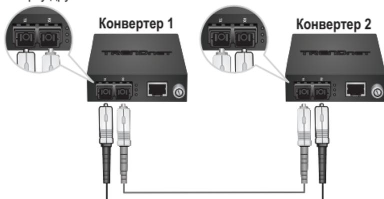
3. Подайте питание, подсоединив адаптер, который идет в комплекте, к оптическому конвертеру и вставив его в розетку.
