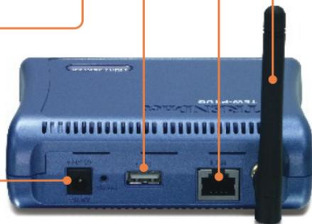
4. Conecte el **adaptador de alimentación AC** al servidor de impresión y luego a una toma de corriente.
