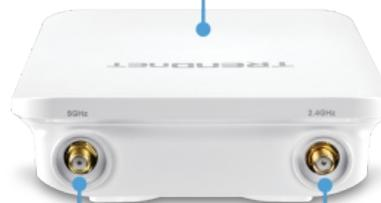
4 connecteurs d'antenne RP-SMA femelles
