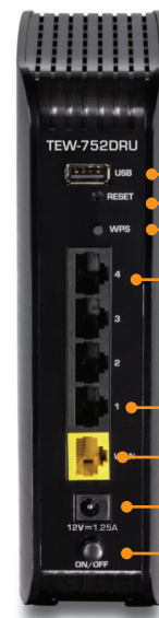
El puerto USB Botón de reinicio El botón WPS Puertos Gigabit Ethernet Puerto Gigabit internet Puerto de alimentación Interrupción de encendido/apagado
