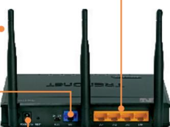
3. Connectez l'extrémité d'un câble RJ-45 au port WAN du TEW-672GR. Branchez l'autre extrémité du câble à votre modem.
