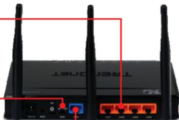
3. Verbinden Sie ein Ende eines RJ-45-Kabels mit dem WAN-Port des TEW-639GR und das andere Ende mit Ihrem Modem.
