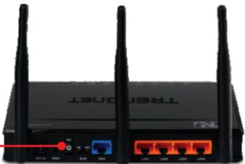
5. Schalten Sie den Netzschalter auf die "ON" Position.
