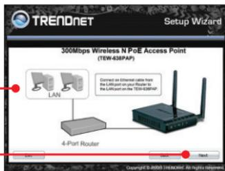
6. Подключите прилагаемый кабель RJ-45 к порту LAN маршрутизатора и порту Ethernet компьютера.
