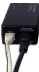
3. Verbinden Sie den Umschalter über ein Kat.-5-Kabel mit dem **DATA IN-Port** des TPE-111GI.
