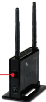
4. Verbinden Sie den **LAN-Port** des TEW-638PAP über ein Kat.-5-Kabel mit dem **PoE Out-Port** des TPE-111GI.
