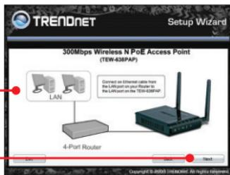
6. Verbinden Sie einen LAN-Port des Routers über ein RJ-45-Kabel mit dem Ethernet-Port Ihres Computers.
