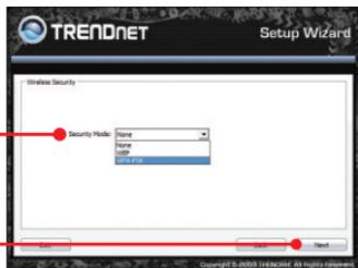
16. Wählen Sie den gewünschten **WPA**-Modus aus, geben Sie einen vorinstallierten Schlüssel ein und klicken Sie dann auf **Next** (Weiter). Für WPA-PSK und WPA2-PSK muss der vorinstallierte Schlüssel 8 bis 63 ASCII- bzw. 64 HEX-Zeichen lang sein. Notieren Sie sich den vorinstallierten Schlüssel.
