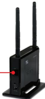
4. Raccordez un câble CAT-5 entre le port LAN du TEW-638PAP et le port PoE Out du TPE-111GI.
