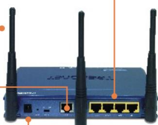
3. Verbinden Sie ein Ende eines RJ-45-Kabels mit dem WAN-Port des TEW-631BRP und das andere Ende mit Ihrem Modem.
