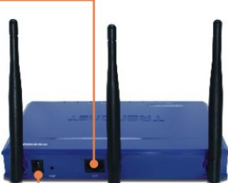
2. Conecte el adaptador de alimentación AC al Punto de Acceso y luego a una toma de corriente.
