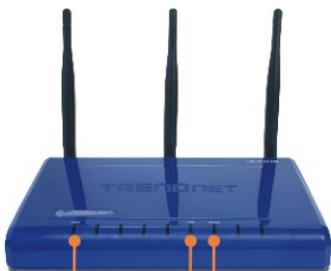
3. Vérifiez que les voyants lumineux suivants, se trouvant sur l'avant, sont allumés : **Power, LAN, et WLAN.**
