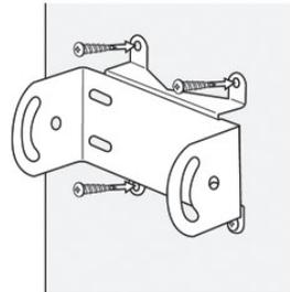
6. Stecken Sie den Montagebügel in die Wandhalterung und befestigen Sie ihn mit den beiliegenden Schrauben und Unterlegscheiben.
