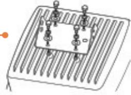
2. Setzen Sie die Wandhalterung in der korrekten Lage an und markieren Sie die Bohrlöcher.
