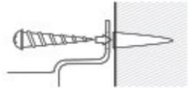
5. Befestigen Sie die Außen-/Schwenkhalterung mit Hilfe der beiliegenden Holzschrauben in den Wanddübeln.
