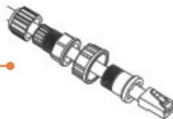
8. Drücken Sie das abisolierte Kabel im RJ-45-Stecker fest.
