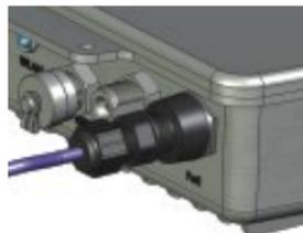
11. Verbinden Sie das andere Ende des Ethernetkabels mit dem **LAN+DC**-Port des PoE-Adapters.
