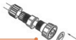
9. Stecken Sie die Dichtung in das Vorderteil des Anschlusses. Bringen Sie dann die Schraubenmutter auf der Rückseite an.
