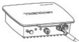
3. Schrauben Sie einen anderen Kabelanschluss (Stecker) an die externe Antenne. Ziehen Sie beide Anschlüsse bitte so fest wie möglich an.
