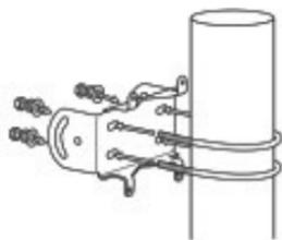
**3.** Befestigen Sie den Haltebügel mit den beiliegenden Muttern und Unterlegscheiben an der Pfahlhalterung.
