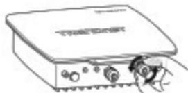
2. Schrauben Sie ein Ende des TEW-ASAL1 an den EXT-Anschluss des TEW-455APBO.
