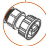
10. Verbinden Sie den Spanning und die Dichtmutter mit dem PoE-Port auf der Rückseite des TEW-455APBO.
