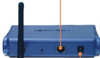
2. Conecte el adaptador de alimentación AC al Punto de Acceso y luego a una toma de corriente.
