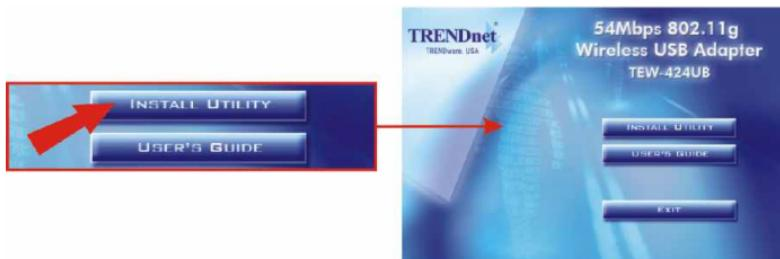
3. Siga las instrucciones del Install Shield Wizard (Asistente Instalador) para instalar las herramientas de configuración inalámbrica.
