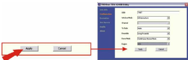
6. Si desea activar la Encriptación, haga clic en el enlace de Encriptación. Haga clic en la caja próxima a la Encriptación de datos, introduzca la clave Wep que corresponda con la configuración de encriptación de red inalámbrica, luego haga clic en **Apply (Aplicar)**.
