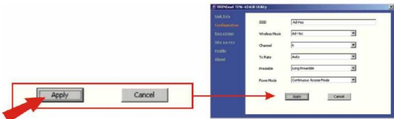
6. Si desea activar la Encriptación, haga clic en el enlace de Encriptación. Haga clic en la caja próxima a la Encriptación de Datos. Introduzca la clave WEP que corresponda a la configuración de encriptación inalámbrica de red, luego haga clic en **Apply (Aplicar)**.
