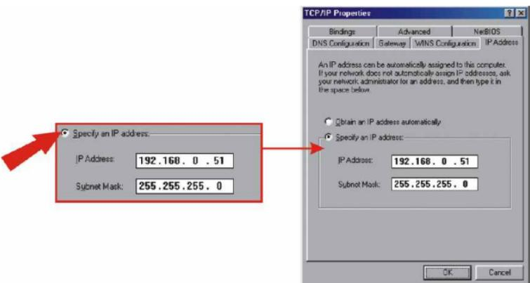
**Nota:** Si su Punto de Acceso inalámbrico a la red o su enrutador inalámbrico incluye una característica de servidor DHCP, habilítela y configure el adaptador inalámbrico para utilizar las direcciones IP DHCP. Después de que el adaptador inalámbrico se conecte al Punto de Acceso o Enrutador, recibirá las direcciones automáticamente.
