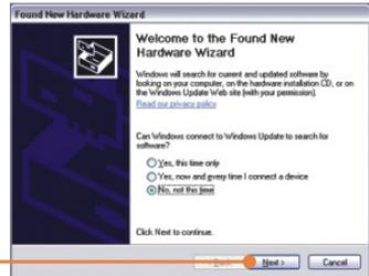
11. Markieren Sie **Install the software automatically** (Software automatisch installieren) und klicken Sie auf **Next** (Weiter).
