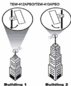
Figure 3.1 : Ajuster le TEW-412APBO/TEW-413APBO pour une meilleure réception
