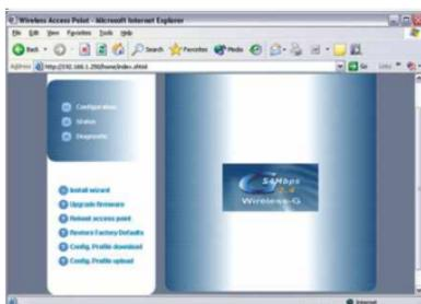
4. Haga clic en el enlace **Install wizard (Instalar asistente)** para configurar el TEW412APBO.
