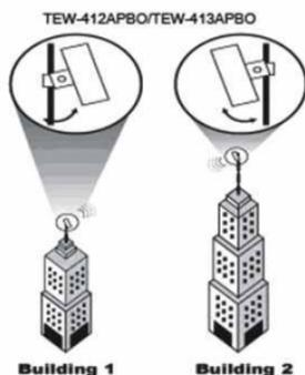
Figura 3,1: Ajustar el TEW-412APBO/TEW-413APBO para una mejor recepción
