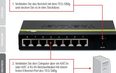
2. Verbinden Sie den Computer über ein KAT.5e oder KAT. 6 RJ-45-Netzwerkkabel mit einem freien Ethernet-Port des TEG-S80g.
