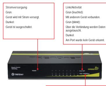
100Mbps/1000Mbps Grun: Port ist mit 2000MBit/s (Voll) Gelb: Port ist mit 100/200MBit/s (Voll-/Halbduplex) Dunkel: Verbindung mit 10/20MBit/s (Voll-/Halbduplex) oder am Port wurde kein Gerät erkannt.
