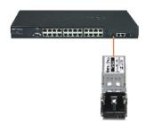
2. Conecte un cable multimodo tipo LC del módulo a un conmutador de fibra Gigabit con conector tipo LC.
