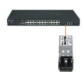
2. Присоедините многомодовый кабель типа LC модуля к коммутатору Gigabit Fiber с помощью разъема типа LC.
