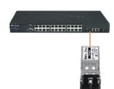
Branchez un câble multi-mode de type LC entre le module et un Switch fibre Gigabit à l'aide d'une prise de type LC.
