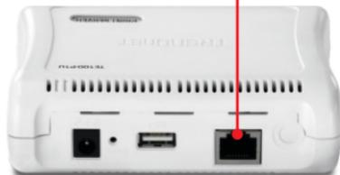
2. Connectez l'imprimante USB au port **USB** du serveur d'impression.
