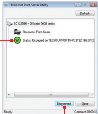
3. Legen Sie das Dokument auf die Scanplatte des Multifunktionsdruckers. Befolgen Sie dann die Hinweise der Druckeranleitung zum Scannen.
