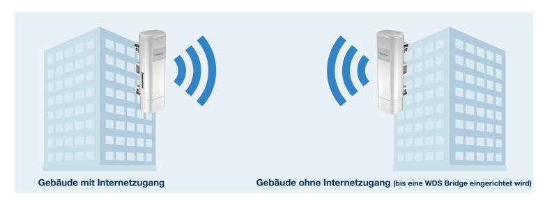
Eine WDS Bridge kann verwendet werden, um Internetzugang mit einem Gebäude zu teilen, das sonst keinen Internetzugang hätte. Dies ist auch eine kostengünstige Lösung, da sie keinen aufwendigen Umbau der bestehenden Infrastruktur erfordert (in dem Gebäude ohne Internetzugang).
