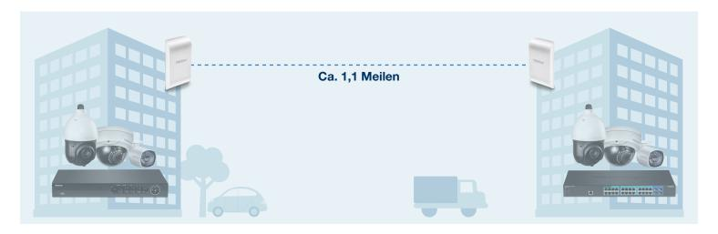
Eine gängige Anwendung für Wireless Bridging ist Überwachung, wenn eine Kabelverbindung nicht möglich ist, zum Beispiel bei einer Installation zwischen zwei Gebäuden oder von einem Gebäude zu einer Stange auf einem Parkplatz. Wireless Bridge Lösungen sind besonders hilfreich bei Installationen an entfernten Orten.
