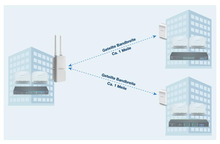
Bei einer Punkt-zu-Multi-Punkt Lösung werden sowohl omnidirektionale als auch direktionale Access Points verwendet. Dies ist eine beliebte Lösung, da sie kostengünstiger sein kann, solange Sie nicht große Mengen an Bandbreite benötigen. Wenn Sie eine Punkt-zu-Multi-Punkt Lösung verwenden, wird Bandbreite mit anderen Access Points innerhalb des Netzwerks geteilt.
